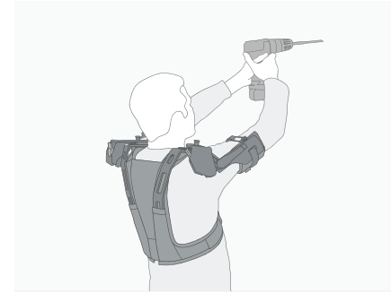
Der DeltaSuit unterstützt Arbeiten oberhalb der Schulterhöhe, wie z. B. die Benutzung eines Werkzeuges oder die Handhabung von Gegenständen oberhalb der Schulterhöhe.
