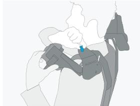
Bloquee la articulación del hombro: Con una mano, tire hacia arriba y sujete el pasador de bloqueo. Gire el manguito del brazo hacia atrás hasta que se detenga contra un tope mecánico. Suelte el pasador de bloqueo. Si el manguito del brazo aún puede moverse, repita los pasos.
