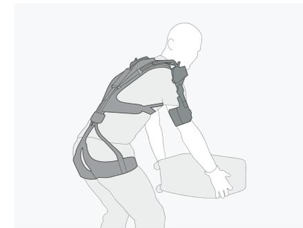
El OmniSuit permite trabajar en posiciones de flexión hacia delante y levantar objetos por debajo del nivel de la cadera cuando se activa el módulo de soporte de la espalda.
